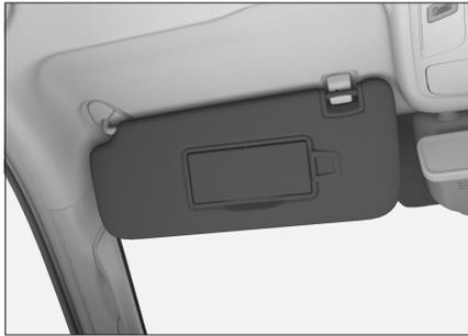
Cuando la luz del sol afecta la visión del conductor desde el frente, se puede girar la visera para bloquearla.
