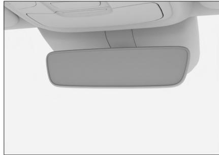
El espejo retrovisor interior reducirá automáticamente el reflejo en función de la intensidad luminosa del faro del vehículo que circula detrás.
