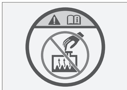
Esta etiqueta está ubicada en la tapa del radiador para recordarle que no debe abrir la tapa del radiador cuando el motor está sobrecalentado. De lo contrario, existe riesgo de quemaduras o salpicaduras de refrigerante.
