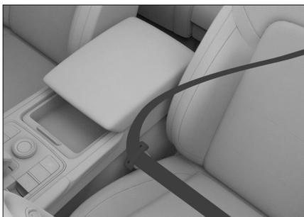
3. Tire hacia arriba del cinturón de seguridad del hombro y ajuste el cinturón de la cintura para que quede bien ajustado al cuerpo. De esta manera, el impacto puede ser absorbido por la pelvis, que es más resistente, reduciendo la posibilidad de lesiones.
