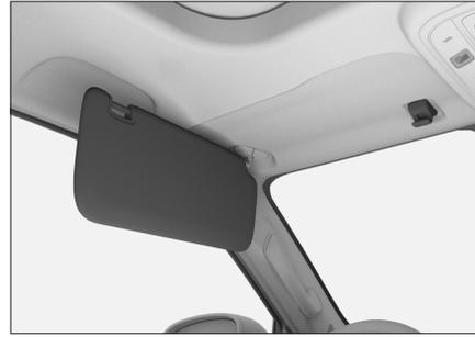
Cuando la luz del sol afecta la visión del conductor desde el lado, se puede girar la visera para bloquearla soltando el gancho.
