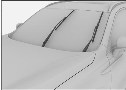
2. Levante el brazo del limpiaparabrisas del parabrisas.
