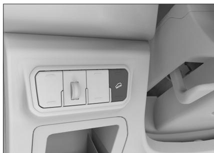
Con el interruptor de encendido en modo ON o después del arranque del vehículo, pulse el botón para activar o desactivar el control de descenso en pendientes (HDC).
