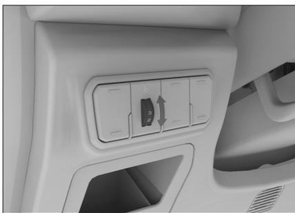
La altura del haz de luz se puede ajustar en función del número de pasajeros y de la carga del vehículo.
